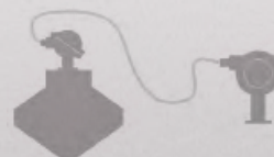
Montagem campo remoto
