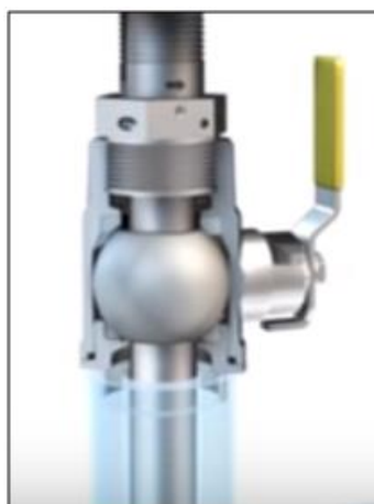
Medidor Instalado Válvula Totalmente aberta
